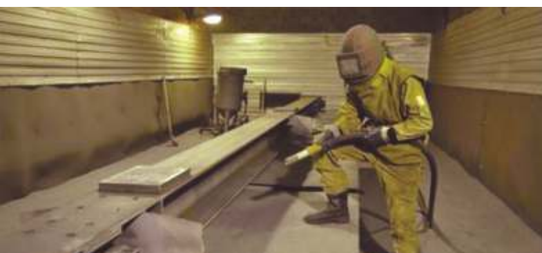
УЧАСТОК ДРОБЕСТРУЙНОЙ ОБРАБОТКИ МЕТАЛЛОКОНСТРУКЦИЙ
