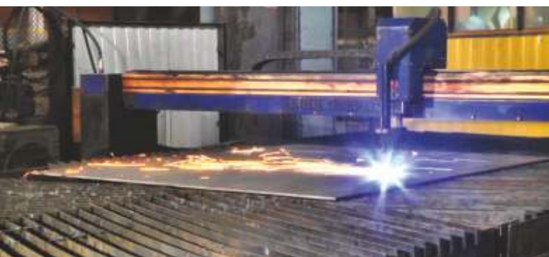
УЧАСТОК ПЛАЗМЕННОЙ РЕЗКИ МЕТАЛЛА
